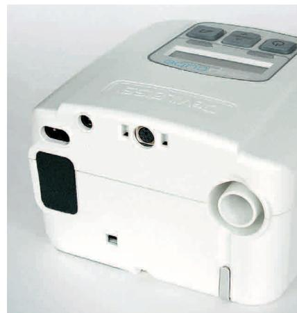
A l'arrière de la PPC : un filtre, la sortie du tuyau patient et sortie PC
